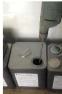
液材のみの混合重量比 B材：C材＝7：3
