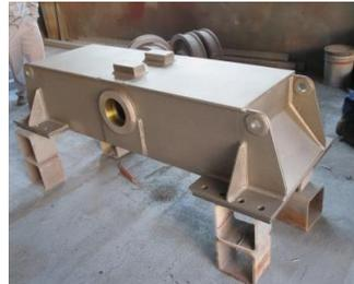
標準塗布量 : 0.5kg/m<sup>2</sup>/回 (刷毛塗り)
