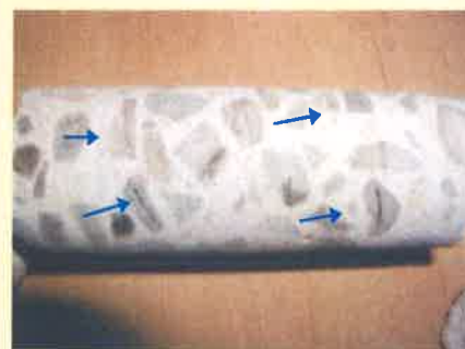
照片1 因鹼性骨材反應導致的 骨材龜裂
