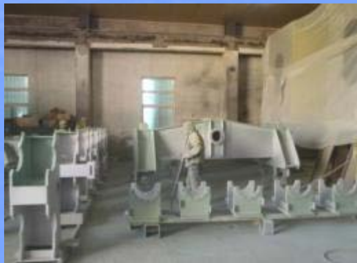
上塗材 塗装状況
