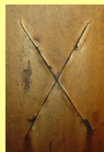
スラグリードSR-1 劣化
